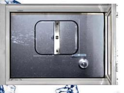
Steigt der Wasserpegel im Lichtschacht an, bewegt sich die Hohlkugel leicht nach oben und löst einen Mechanismus aus, der mittels Zugfeder den Lüftungsdeckel an die fest installierte Acrylglasplatte drückt. Der Hochwasserschutz ist aktiviert. Sobald der Wasserpegel wieder gesunken ist, stossen Sie einfach den Lüftungsdeckel wieder nach aussen.
